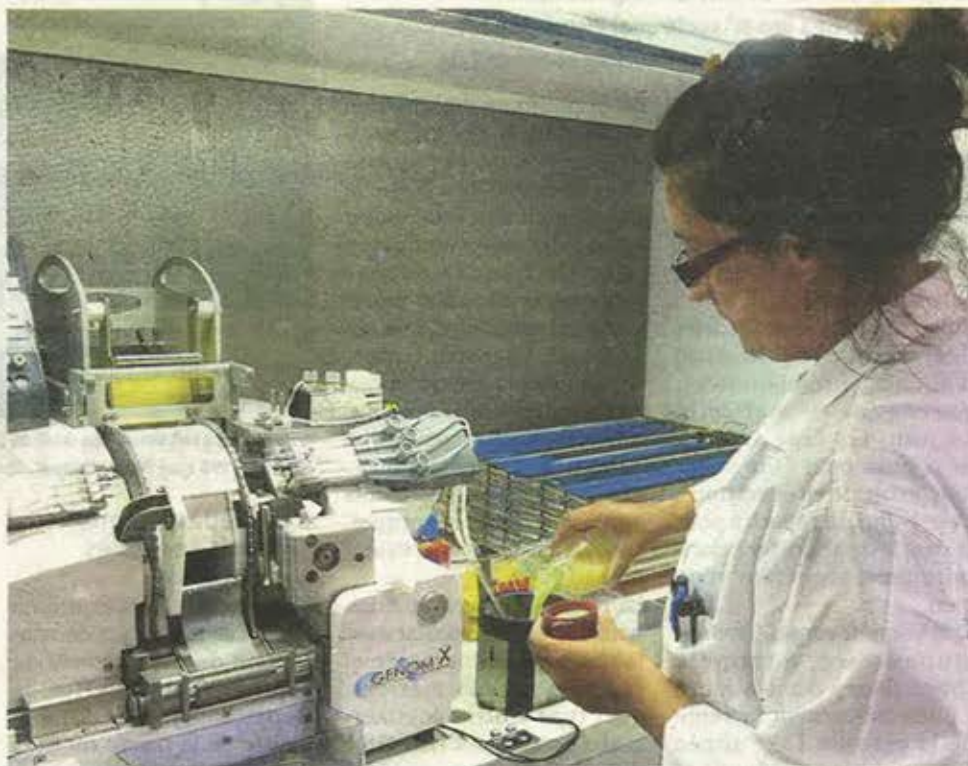
■ Amandine devant le robot automatisé Genom X, destiné à la mise en paillettes des semences. Photo J. Z.
